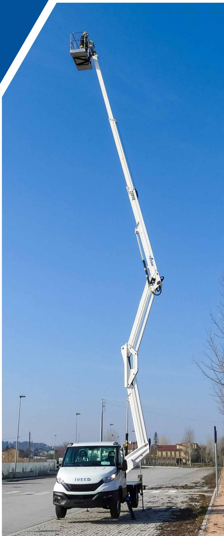
La nouvelle nacelle élévatrice B220PXE intègre la double articulation "up-and-over" avec un bras télescopique innovant et un panier monté en bout.
