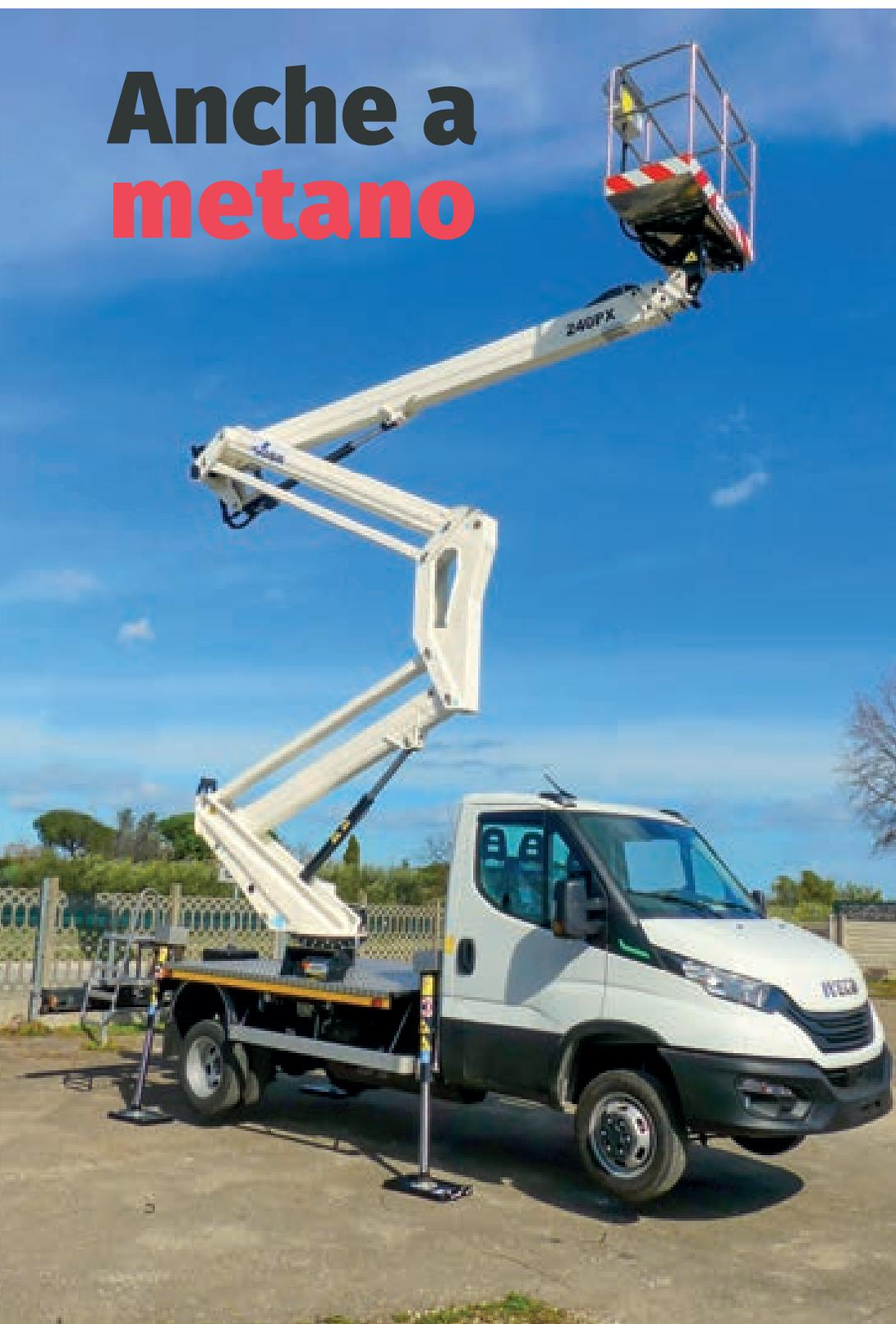
**L**a piattaforma GSR doppio-articolata B240PX viene ora proposta anche in una versione ad alimentazione alternativa. Nello specifico si tratta di una macchina allestita su un Iveco Daily a metano, che presenta un piccolo serbatoio a
