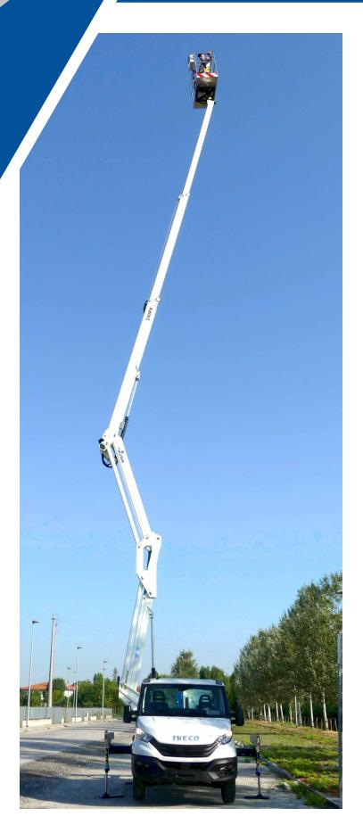
La piattaforma GSR B240PX introduce una nuova caratteristica nel concetto di doppia articolazione "up-and-over". Mantenendo i tradizionali livelli di rigidità e robustezza della gamma PX, questo nuovo modello ha come punto di forza la rotazione senza restrizioni con 250kg di portata.
